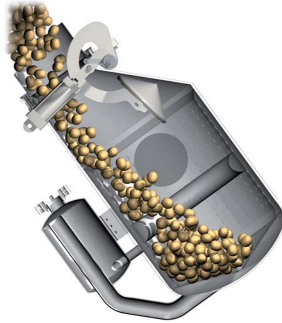
Dubbelwandig schilvat met uitwendige condensaat opvangtank
